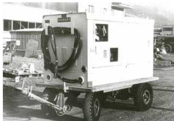
23 • Selbstfahrender Plattformwagen mit einem Notstromaggregat für die ehemalige Swissair
