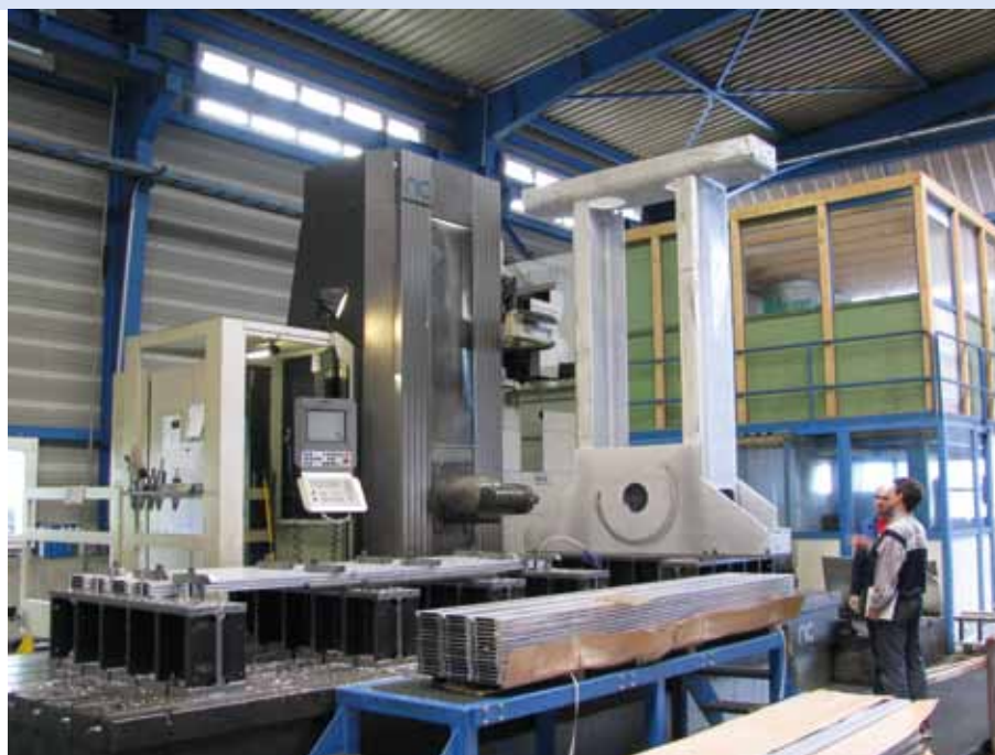
84 • Bearbeitung Antriebschassis für eine Seilbahn in der Grossbearbeitung
