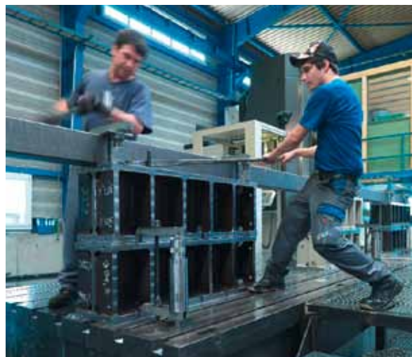
80 • Werkstückaufspannvorgang in der Grossbearbeitung
