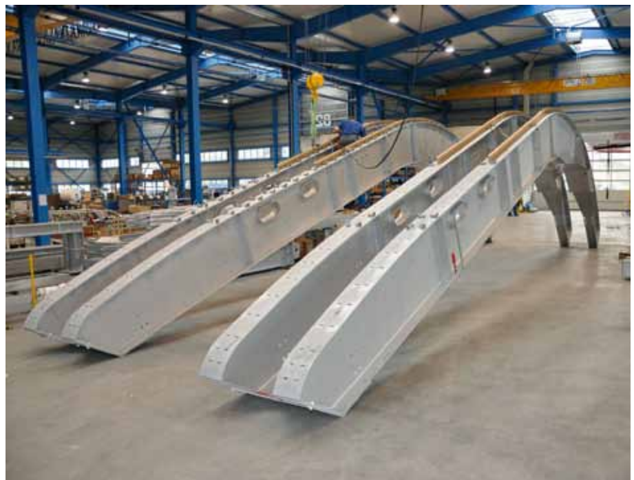
46 • Werksmontagearbeiten Pendelbahn Moléson, Antriebseinheit und Stationseilsattel
