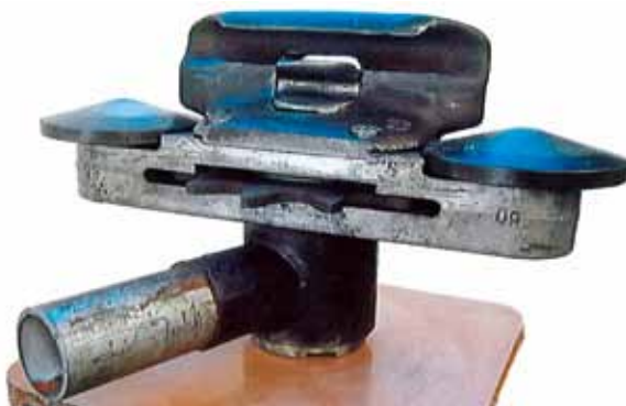
9 • Automatische Klemme mit Zahnrad, 1962
