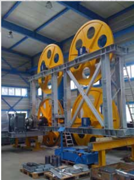
46 • Werksmontagearbeiten Pendelbahn Moléson, Antriebseinheit und Stationseilsattel
