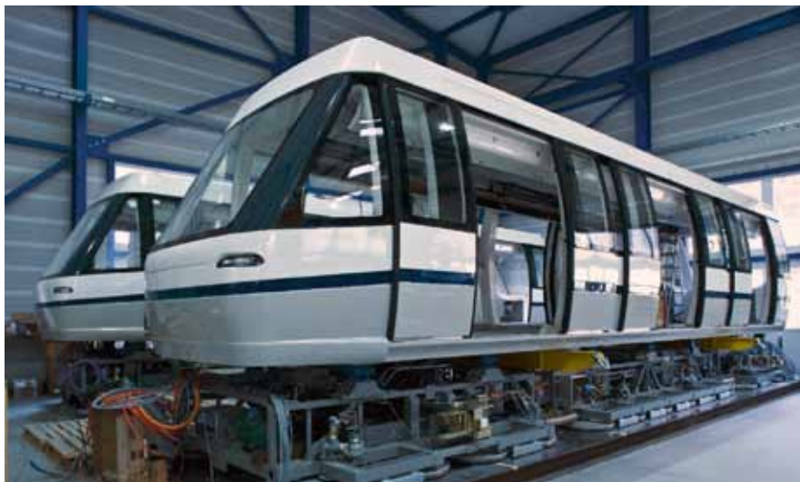
90 • 2009: Werksmontage der Skymetro-Züge für den Flughafen Zürich, seilgezogen auf Luftkissen
