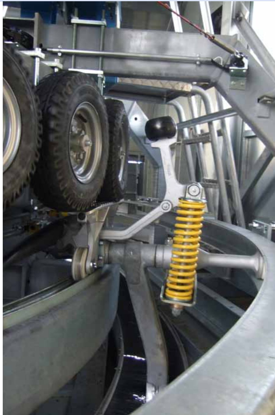
33 • Fahrzeug mit offener Klemme in der Stations- durchfahrt
