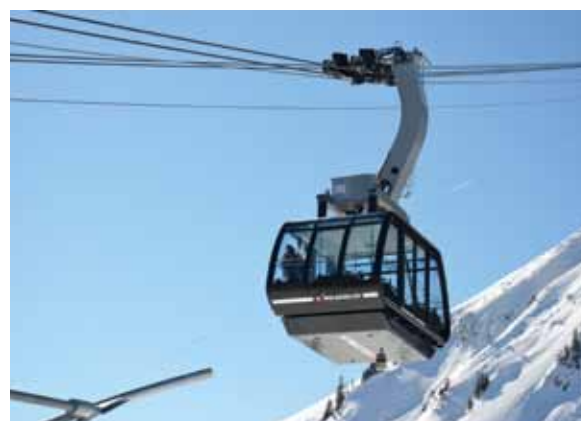
44 • Pendelbahn Moléson, Laufwerk mit Fangbremse und 60-Personen-Kabinen
